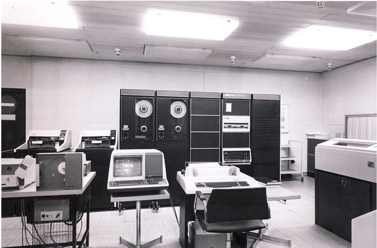
Figure 1: Computador PDP-11/70 ao fundo da sala, com um terminal de vídeo e um teletipo à sua frente
