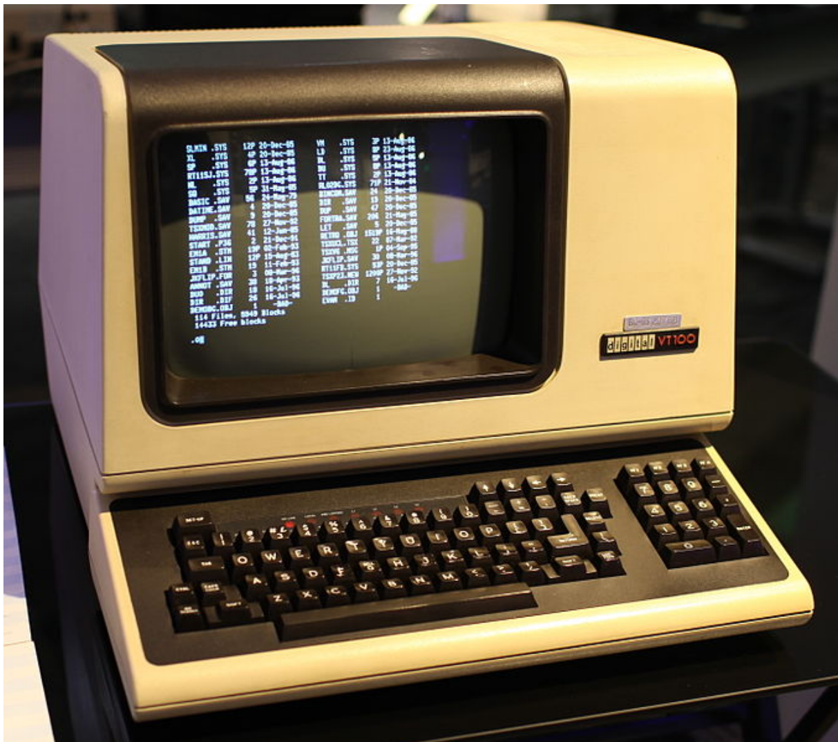
Figure 2: Terminal VT100, usado para comunicar com o computador PDP-11/70
