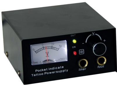
A fonte é o equipamento que fornece energia elétrica à máquina (através do clipcord). Pode ser analógica ou digital e deve fornecer uma amperagem maior do que a consumida pela máquina (que normalmente é de 1 A a 1,5 A, então o ideal é que a fonte forneça pelo menos 2 A). É na fonte que se regula a voltagem fornecida à máquina, que varia de acordo com a própria máquina, a agulha e o modo de trabalho do tatuador.
